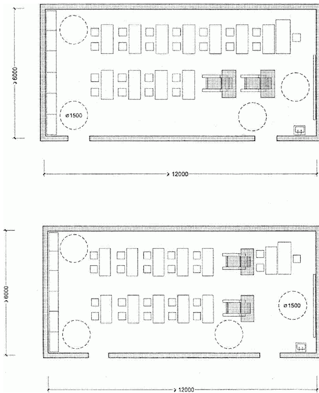
Рисунок Б.3 - Варианты планировочных решений классных помещений площадью около 60 - 70 м 2
